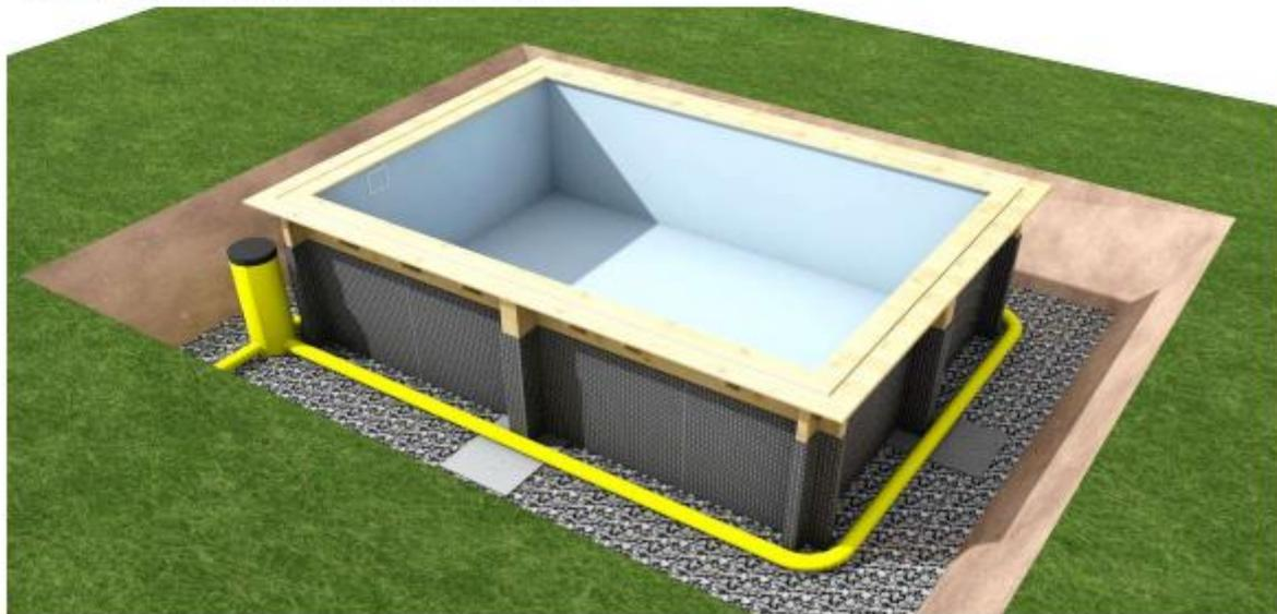
Die Grube, worin sich das Becken befindet, muss gleichmäßig mit dem Anstieg des Wasserspiegels befüllt werden.
